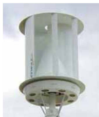
図表 27 小型風力発電機 （サボニウス風車）
