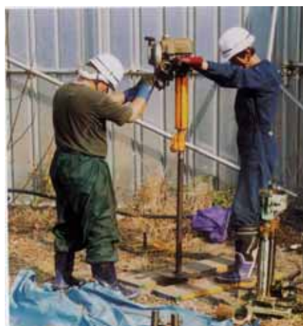
図表 29 機械簡易ボーリングを用いた調査の様子
