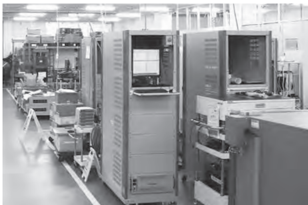
検品中の充放電評価装置が並ぶ東洋システム㈱の工場
