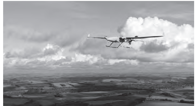
長時間自律航行可能な垂直離発着 (VTOL) 型小型無人機 (英国、Calen-Lenz社提供)
