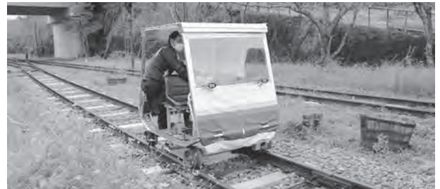
営業前に安全点検用のカートで試運転
