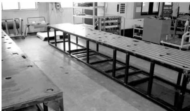
平面切削前後のベース部分（右が加工後）～(株)鳥取メカシステム
