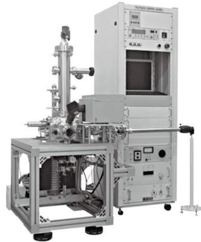
（株）管製作所が完成させた光放出電子顕微鏡
