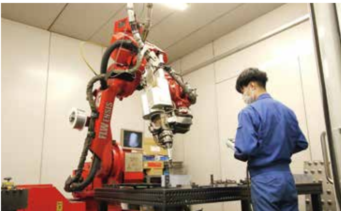
北上工場稼働する高精度溶接ロボット。高品質な製品づくりを支えている
