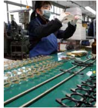
ノーズパッドを貼り付け、さまざまな角度で左右バランスを確認する
