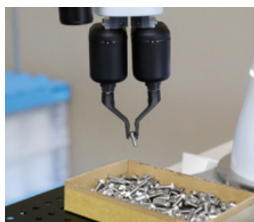
なぞって、まさぐりながらつかむロボットハンド「Think Hand F」(右)。赤外線とAIを用いた近接覚センサーを備え、透明な物もつかむことができる(左)
