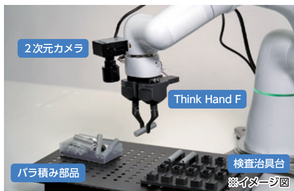
ロボットハンド「Think Hand F」と2次元カメラによる画像解析を組み合わせた「Thinker Model AJ」。バラ積みピッキング用ロボットとして今後の普及が期待される
