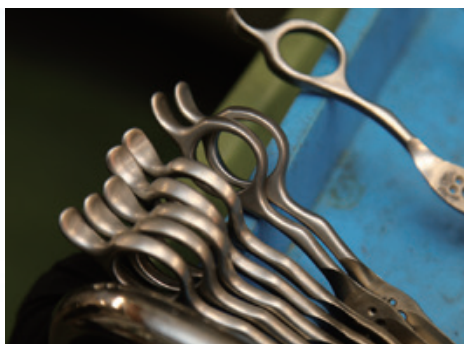
職人の技から生まれる美しい鋏。研磨から仕上げまで、1枚の刃にこだわり抜く。鋏のかみ合わせはマイクロン単位の精度が求められる
