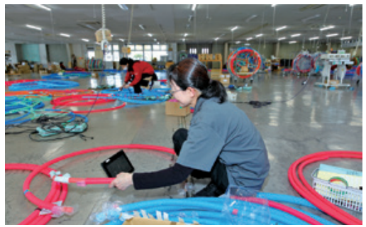
青が給水、赤が給湯のパイプ。ペーパーレス化が進んだ作業場で、タブレットで指示書を確認しつつ組み立てる
