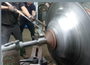
■ヘラ絞り ヘラ棒を押当てて丸みをつける「ヘラ絞り」を行います。ティンパニは、特に力加減が難しく、職人の高い技術力が求められます
