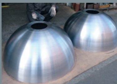
■原型の完成 原型が仕上がった後、うろこ模様をたたき出し、皮を張り部品を付けてティンパニが完成します
