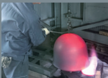
■焼きナマシ 硬化した品物に熱を加え軟らかくする「焼きナマシ」をして、再びヘラ絞りをを行います。この工程を4回繰り返します
