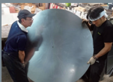
■金属板のカット 金属板を丸く切り出して、絞り機に取り付けます
