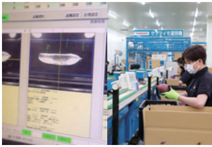
出荷作業棟では、「非破壊内部品位計」を導入し、細密な仕分けをスピーディーに行っている
