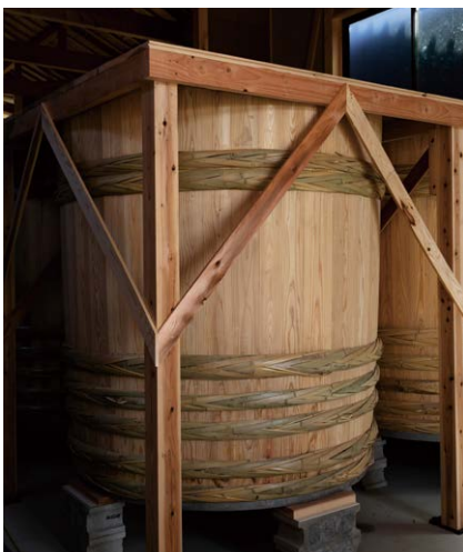
左／150年前から使われ、無数の菌がすみ着いた木桶。醤油の塩分により雑菌が生きられないため、仕込みが終わっても洗わずに使い続ける。 右／山本氏ら仲間で作った新桶。すでに新しい木桶を使った醤油の仕込みが始まっている
