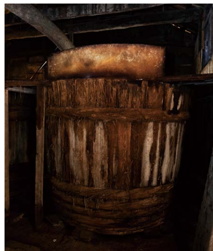
左／150年前から使われ、無数の菌がすみ着いた木桶。醤油の塩分により雑菌が生きられないため、仕込みが終わっても洗わずに使い続ける。 右／山本氏ら仲間で作った新桶。すでに新しい木桶を使った醤油の仕込みが始まっている
