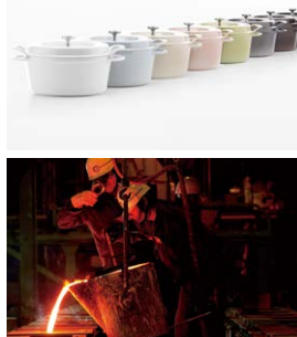
上／究極の無水調理で素材本来の旨みを引き出すバーミキュラ 下／最初の鋳造工程・注湯の様子
