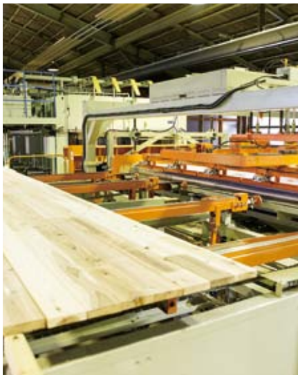
上／構造材として優れているだけでなく、木材需要拡大の可能性も秘めるCLT 左／本社工場のCLT製造プレスライン。板材をパネル状に束ね、それを交互に重ねて接着する
