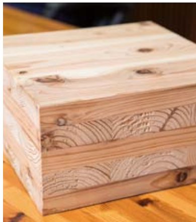
上／構造材として優れているだけでなく、木材需要拡大の可能性も秘めるCLT 左／本社工場のCLT製造プレスライン。板材をパネル状に束ね、それを交互に重ねて接着する
