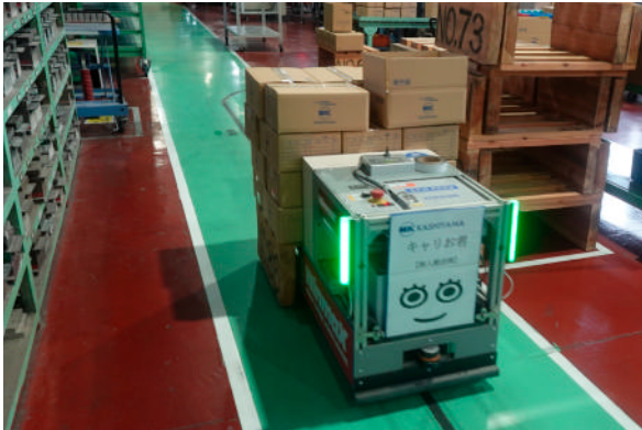
製品や部品の運搬はロボットが担う
