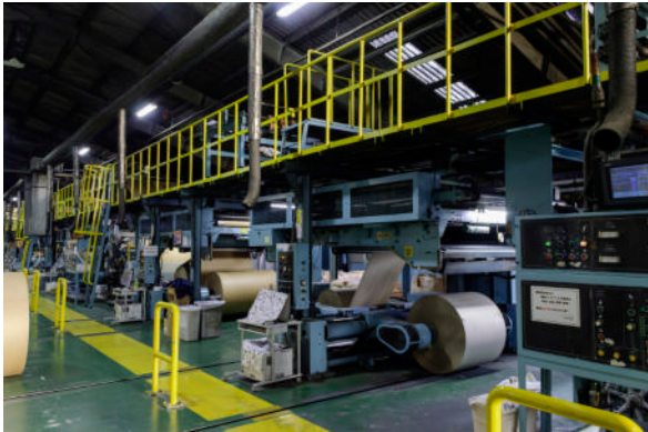
コルゲートマシンで段ボールシートをつくる
