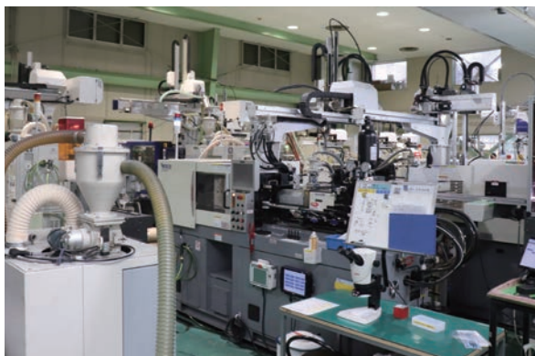
無人で稼働する射出成形機
