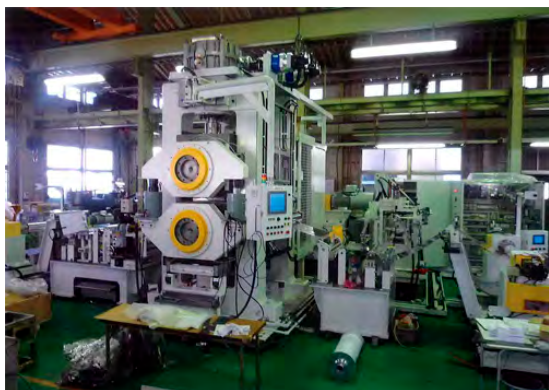
組み立て中の電極製造用のロールプレス
