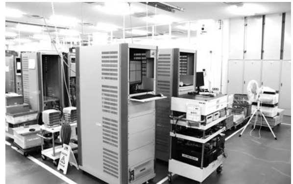
試作した蓄電池に使う充放電評価装置
