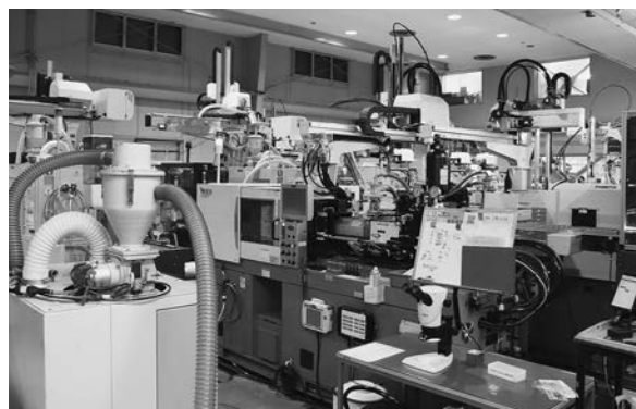
無人で稼働する射出成型機
