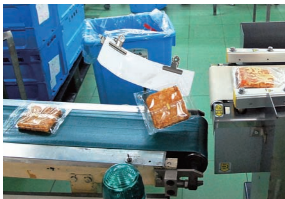
パート女性の「1人1研究」で出たアイデアを実現した「せんべい反転装置」。
