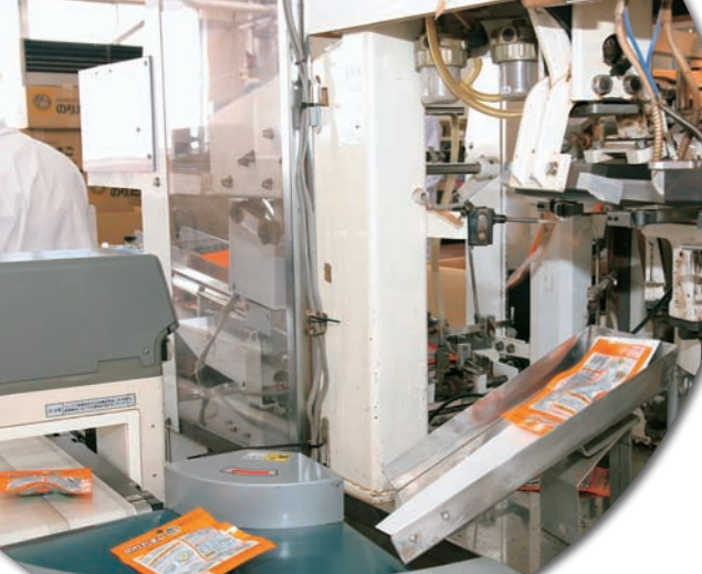
多品種少量生産に対応するため、何台もの自動包装機がひとつの梱包ラインに繋がっている
