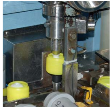
防音対策を施した専用機械を使って、中身を容器に充填する。
