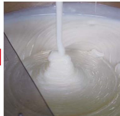
原料のコーンスターチを加熱・攪拌して作られるフエキ糊。独自の技術と微妙な調整を経てできあがる。
