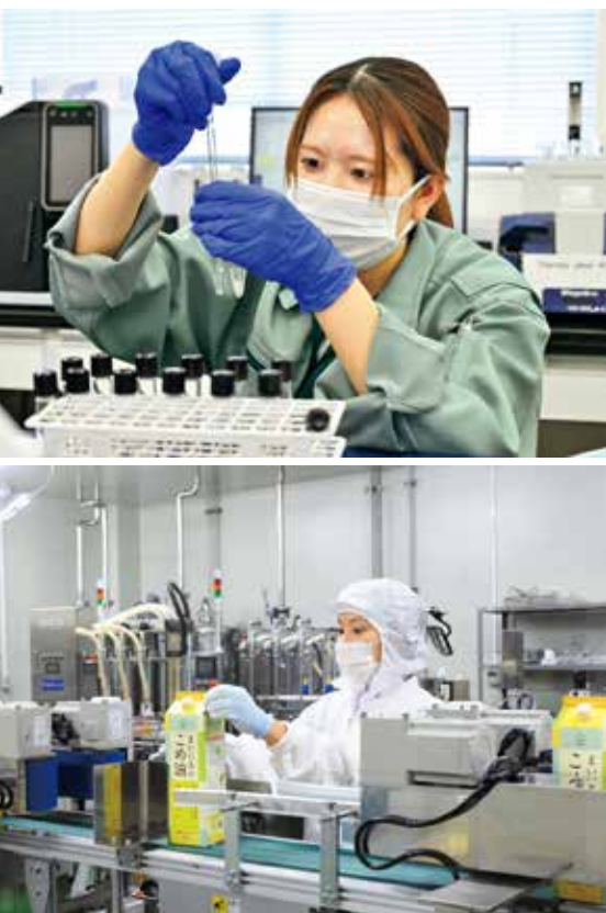
(上) 積極的な研究開発 (下) 業界初、空気清浄度クラス10万のクリーンルームで充填
