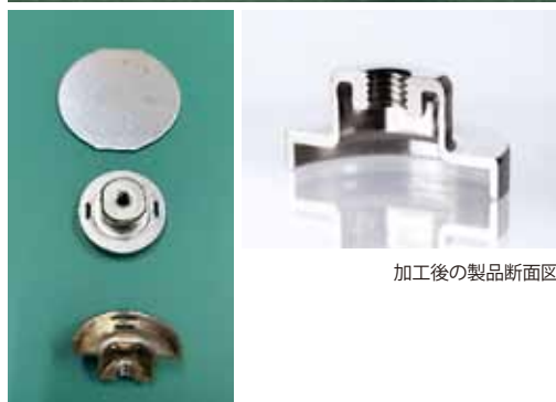
「塑性加工」は、金属を変形させて新たな形状を作り出す技術
