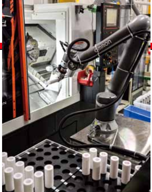
ロボットを活用した無人運転化への取組み
