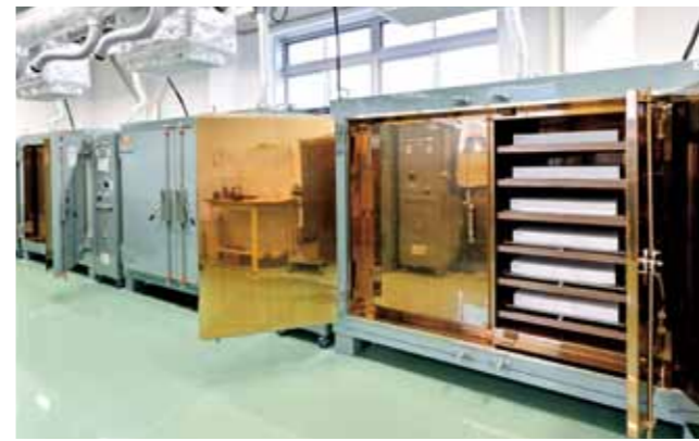
可視化により社内でCO 2 排出量が最も多いことが発覚した焼成炉
