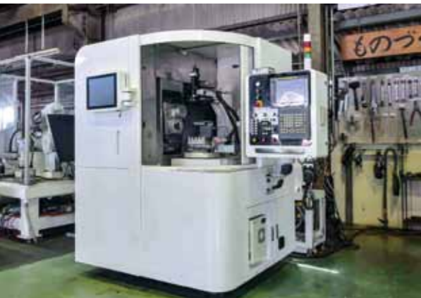
「研削」をテーマに高度な技術力に挑み続けている(上) 多様な意見を取り入れ開発したダイヤモンド工具研削盤(下)
