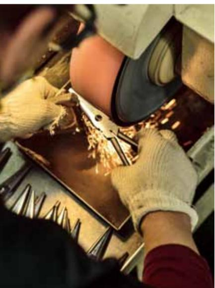
最終段階の研磨作業は、熟練職人により一丁一丁精緻な調整で丁寧に仕上げている
