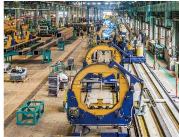
大組立溶接ロボットによる溶接ライン
