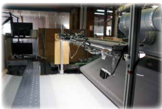
成形した不織布をカメラで撮影する工程
