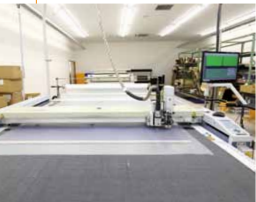
医療用ガウンの布地裁断に導入された大型裁断機
