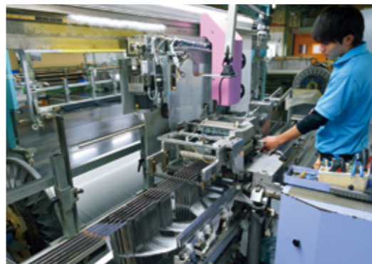
ドローイング工程①：経糸を綜統・箆に通す工程で、織機に掛けるための重要な前作業
