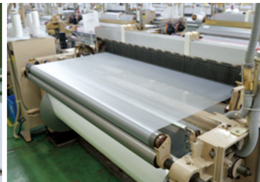
織り工程：経糸を交互に開き、その開口部に水の力で緯糸を打ち込むことで生地を織りあげている
