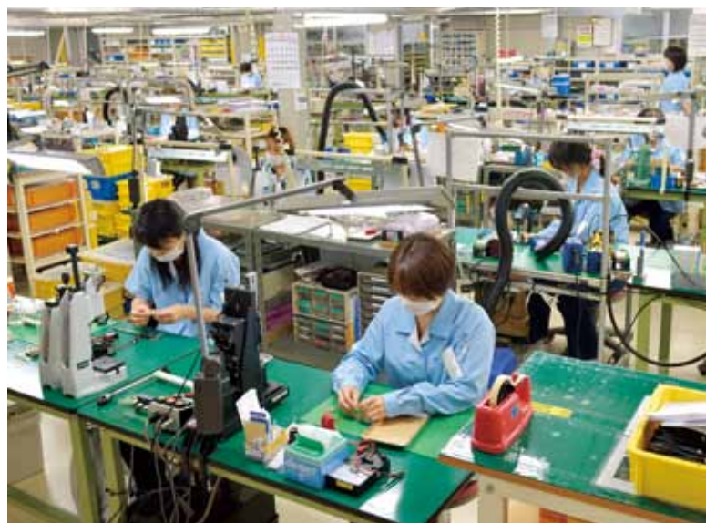
組立工程はライン式ではなく、「1個流し方式」で一入ひとりが違った製品を作り上げている
