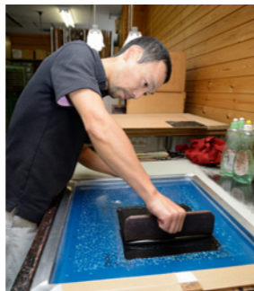
鹿革の上に模様を切り抜いた型紙を置き、その上からへらで漆を丁寧に均等に塗り込んでいく
