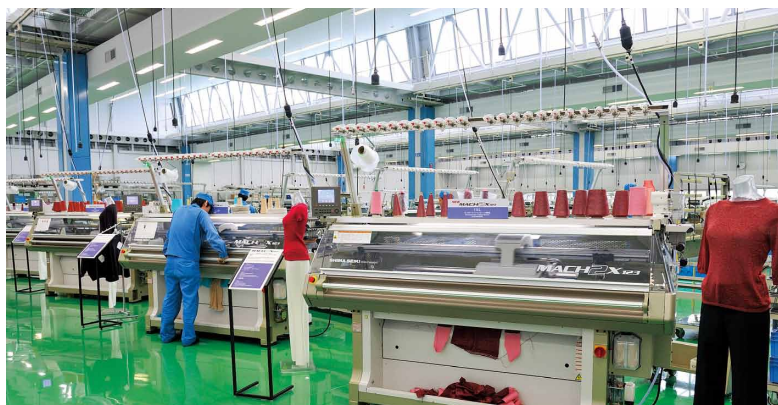
自然光を取り入れ、明るく環境にも配慮されたホールガーメント横編機の組立ライン
