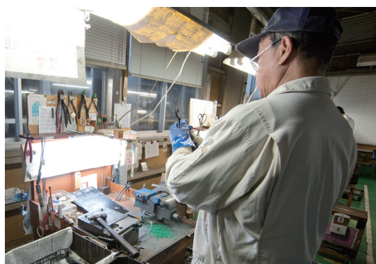
熟練工の手による仕上げ作業。刃と刃の間に、蛍光灯にかざして光がもれるくらいの隙間を開けることにより、鋭い切れ味に。
