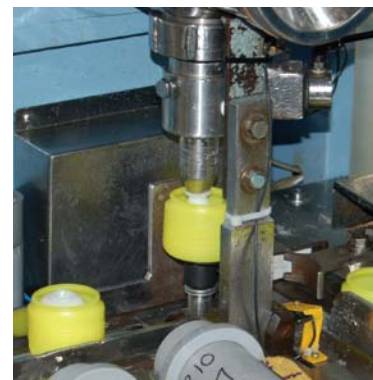
防音対策を施した専用機械を使って、中身を容器に充填する。
