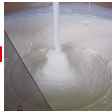
原料のコーンスターチを加熱・攪拌して作られるフエキ糊。独自の技術と微妙な調整を経てできあがる。
