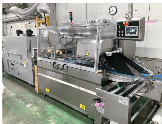
プロセスセンター内に設置した青果シュリンク包装機
