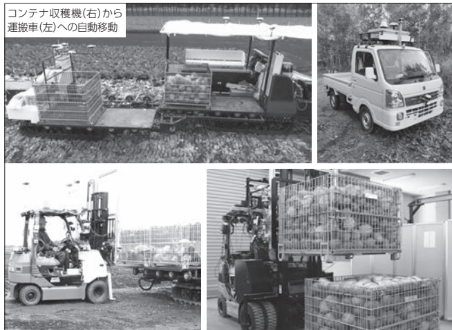
図2 コンテナ収穫機・運搬車(左上)・自動小型トラック(右上)・自動フォークリフト(下)
