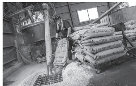
飼料米が入った大袋を天井から吊るして粉碎機に投入する(上) 地元産の麦などを加え自家配合する(下)
