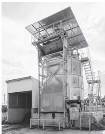
肥育舎の床はすのこ風で、溝に落ちたふんや尿は、分別して処理設備へと運ばれる(上) 全自動で攪拌して堆肥化する密閉型の発酵槽(右下) 長時間かけてさらさらした堆肥になる(左下)
