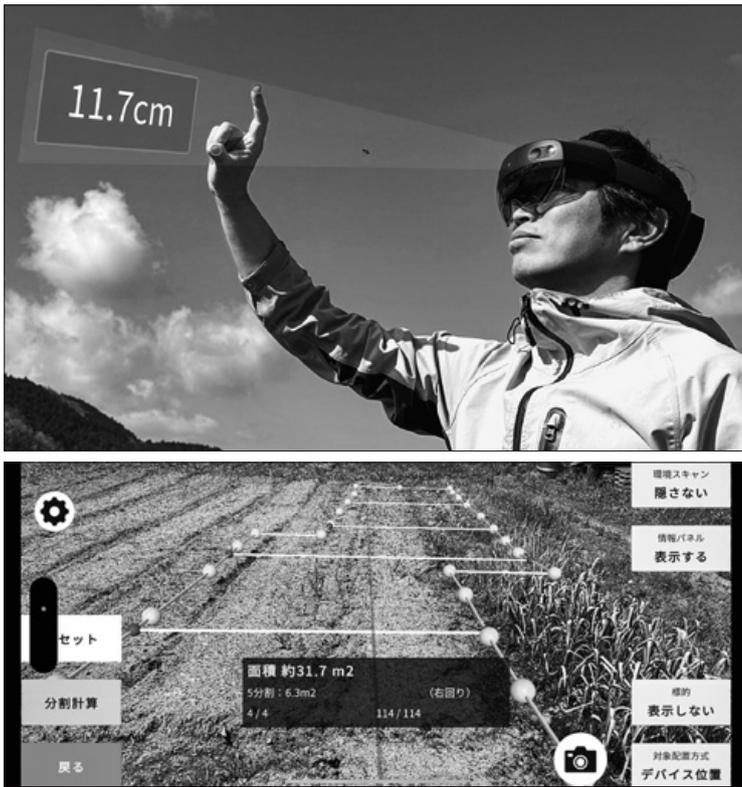
眼鏡型端末のスマートグラスを装着(上) 実際の畑に指で点描していくと、デジタル情報が重ね合わされ、線引き・設計。面積が自動計算され表記される(下)
