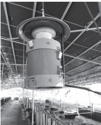
牛舎に設置したライトトラップ。牛舎に集まったヌカカを筒の中に吸い込む
