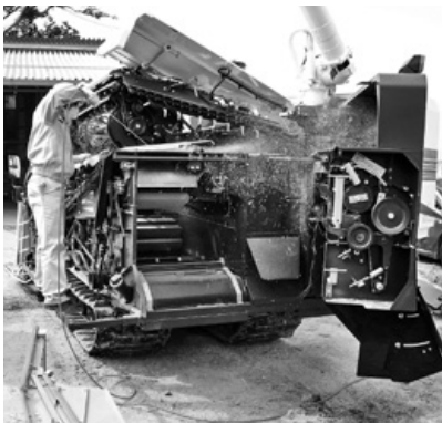
コンバインの機内を清掃する様子
