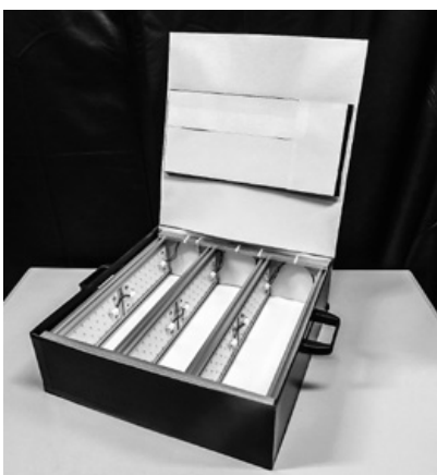
果実発色促進装置。果実の形状や大きさに合わせて仕切り板の位置を調整できる
