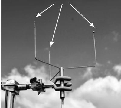
気温Tは3つのセンサの測定結果をもとに  $T_1 + (T_2 - T_3) \div 2$  で求められる ( $T_1 \sim T_3$  は各センサの温度)
