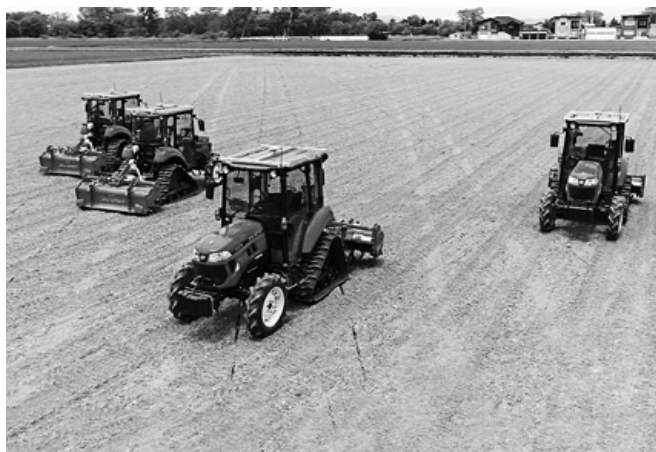
有人監視のもと、無人で走行する4台のロボットトラクターによる協調作業の実演風景。各トラクターにはGPSガイダンスが取り付けられている(岩見沢市内)
