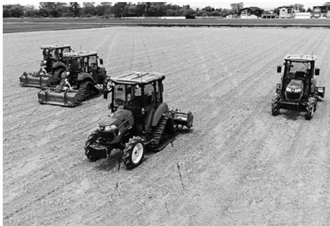
有人監視のもと、無人で走行する4台のロボットトラクターによる協調作業の実演風景。各トラクターにはGPSガイダンスが取り付けられている(岩見沢市内)
