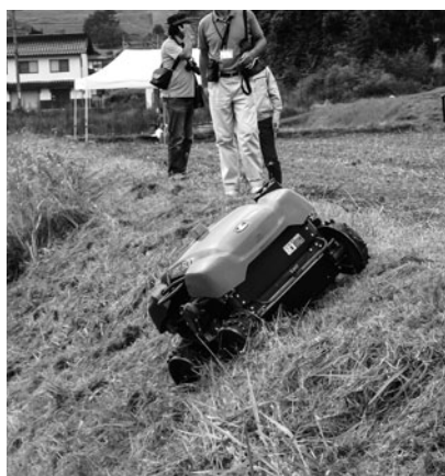
リモコン式草刈機の法面実演（広島県東広島市で／2019年8月22日）
