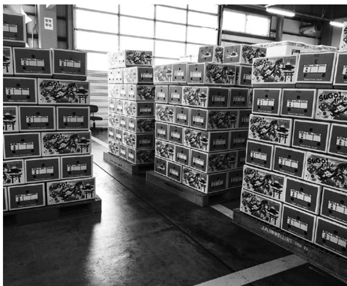
コンテナで高く積めるよう工夫された段ボール箱
