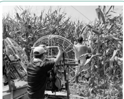
人工送風機によるトウモロコシの倒伏試験
