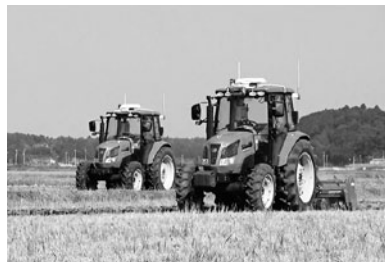
最先端技術を搭載したロボットトラクタ。タブレット一つで農作業が進められる
