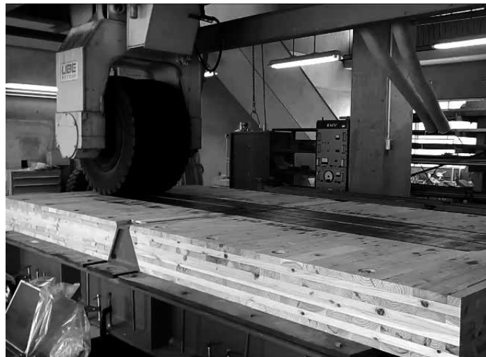
写真3 輪荷重走行試験 (山口大学工学部)
